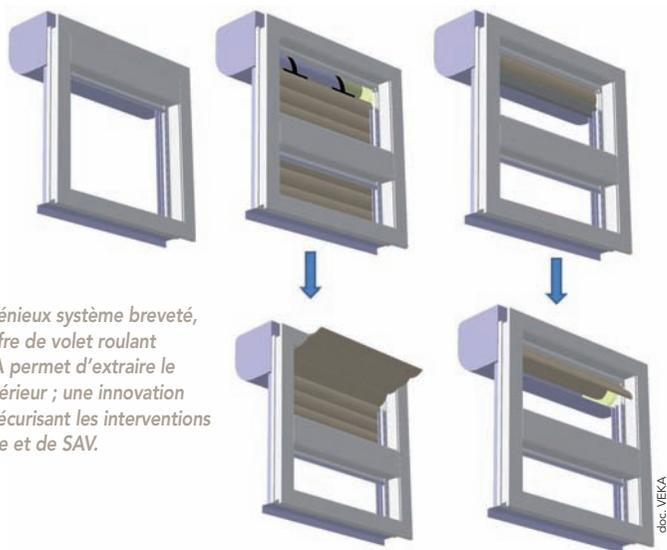
Grâce à un ingénieux système breveté, le nouveau coffre de volet roulant extérieur VEKA permet d'extraire le tablier par l'intérieur ; une innovation simplifiant et sécurisant les interventions de maintenance et de SAV.
